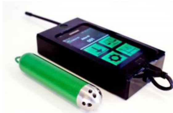
شکل ۱- بلوس اندازه گیری pH و گیرنده مربوطه استفاده شده در آزمایش Figure 1. The bolus of measuring pH and relative receiver that used in the experiment
